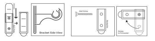
**NOTE:** MINIMUM CLEARANCE REQUIRED BETWEEN THE TOP OF THE BACKPLATE TO THE CEILING IS **37MM**
